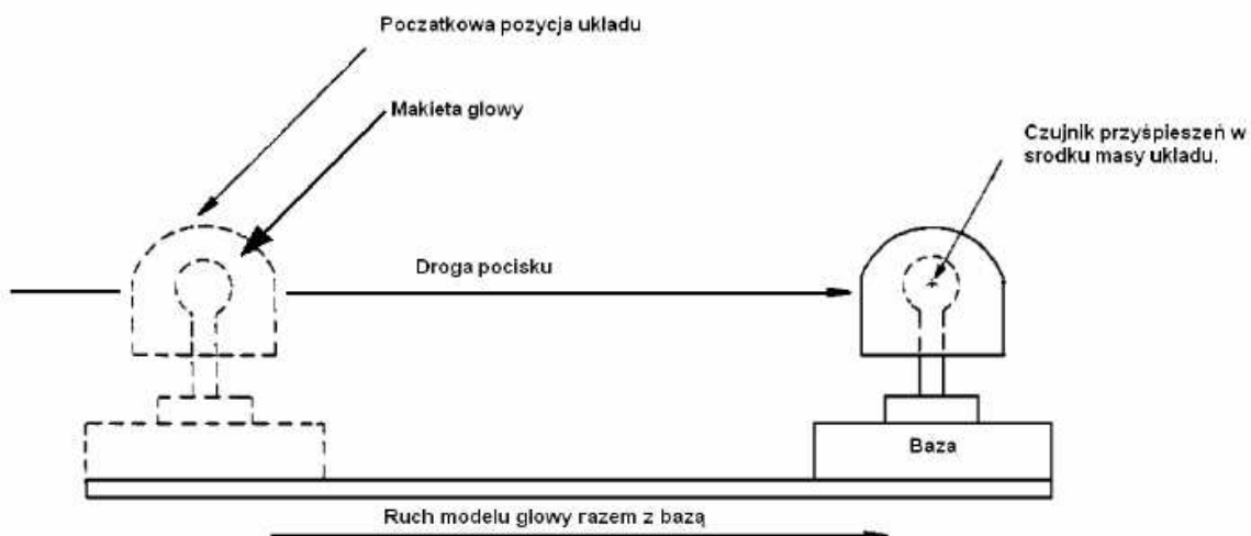
Rys. 2. Przykład urządzenia do badań stopnia pochłaniania energii pocisku przez hełm.
